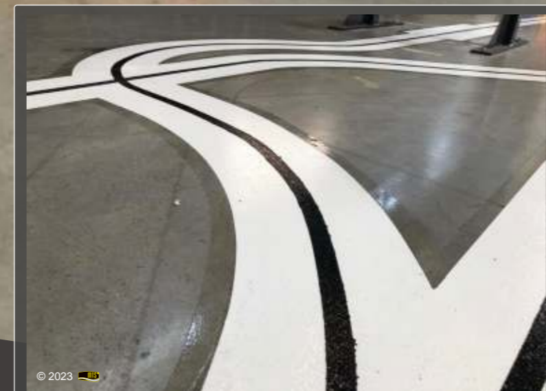
Fahrwege mit Weichenstellung für FTF Fahrerlose Transportfahrzeuge
